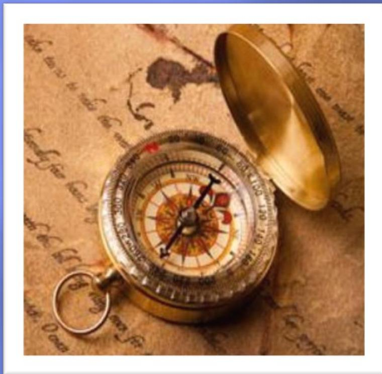
Значительно усовершенствованный вид компас приобрёл в **начале XIV века** благодаря итальянцу **Флавио Джойя**. Он надел магнитную стрелку на вертикальную шпильку, а стрелку прикрепил к лёгкому кругу — картушке, разбитому по окружности на 16 румбов. А в XVI веке картушку и коробку со стрелкой поместили в кардановый подвес, чтобы избежать влияния качки корабля на показания компаса.
