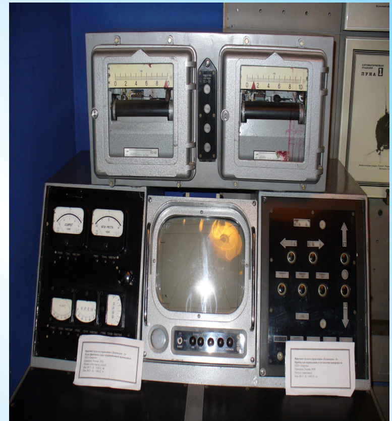
Пульт дистанционного управления Луноходом
