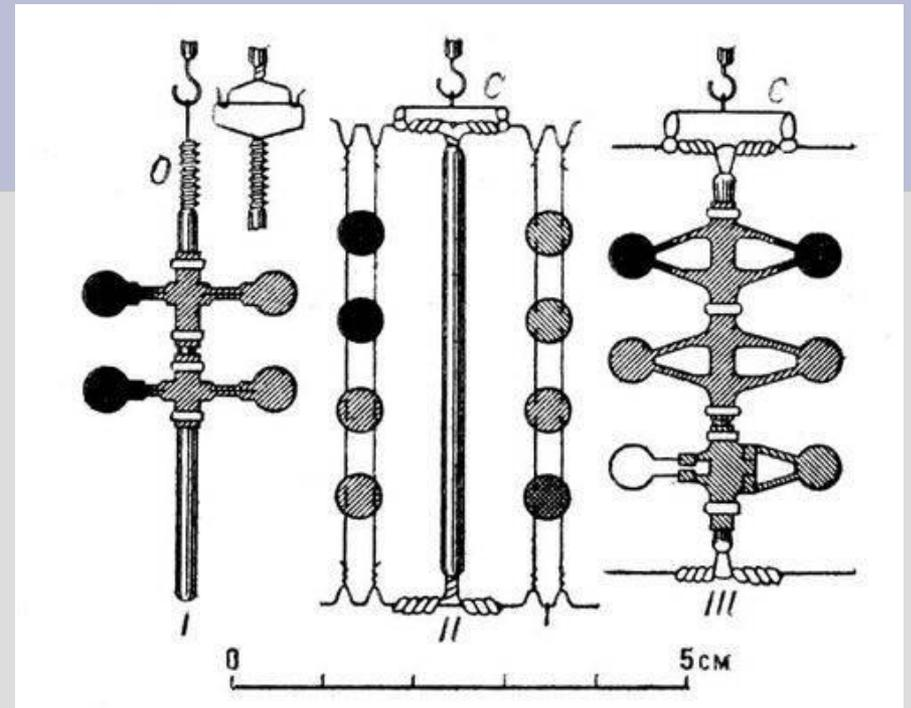
По виду прибор П. Н. Лебедева был простым. Свет от вольтовой дуги падал на лёгкое крылышко, подвешенное на тонкой нити в стеклянном баллоне, из которого выкачан воздух, и по закручиванию нити можно было судить о световом давлении.
