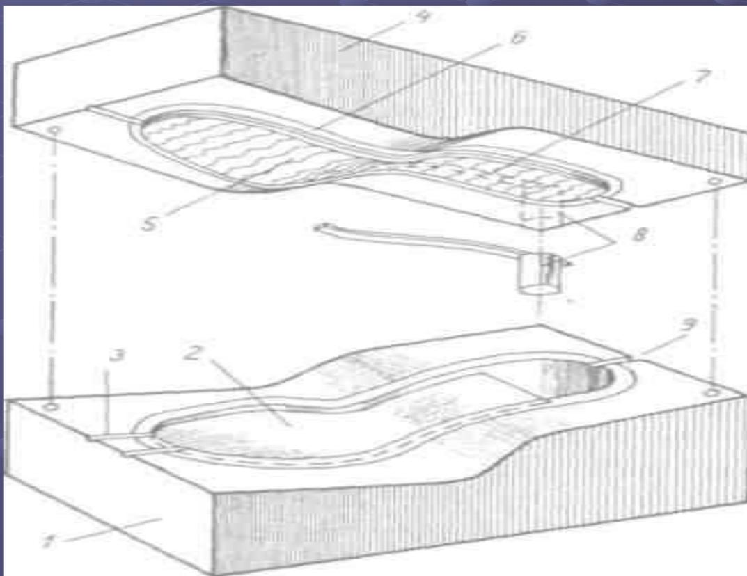
3. **Литьевой метод** – один из прогрессивных, высокопроизводительных химических методов крепления подошвы.
