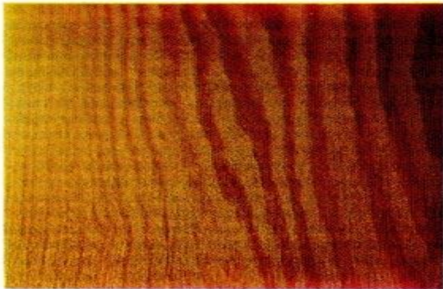
1. Текстура древесины лиственницы сибирской на тангенциальном разрезе.
