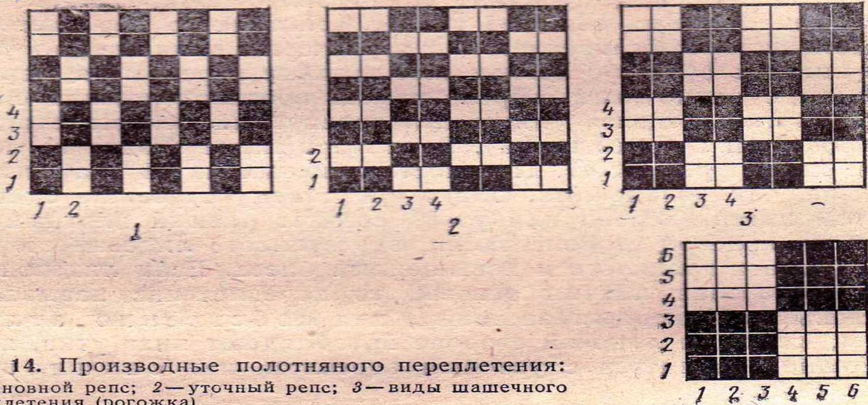
Рис. 14. Производные полотняного переплетения: 1—основной репс; 2—уточный репс; 3—виды шашечного переплетения (рогожка)
