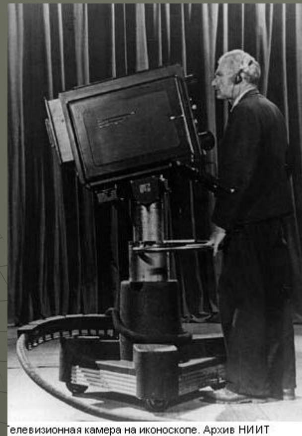
Телевизионная камера на иконоскопе. Архив НИИТ
