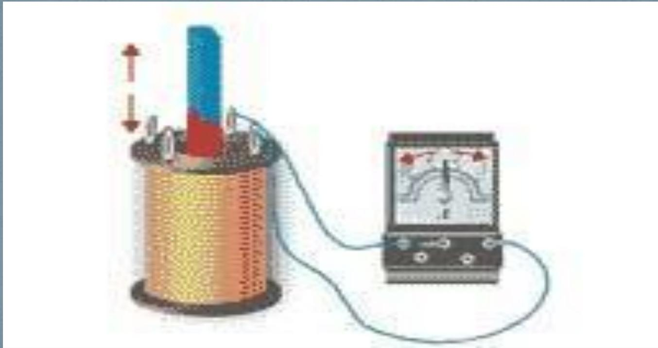
Для получения переменного тока используют в основном **электромеханические индукционные генераторы**, т.е. устройства, в которых механическая энергия преобразуется в электрическую.
