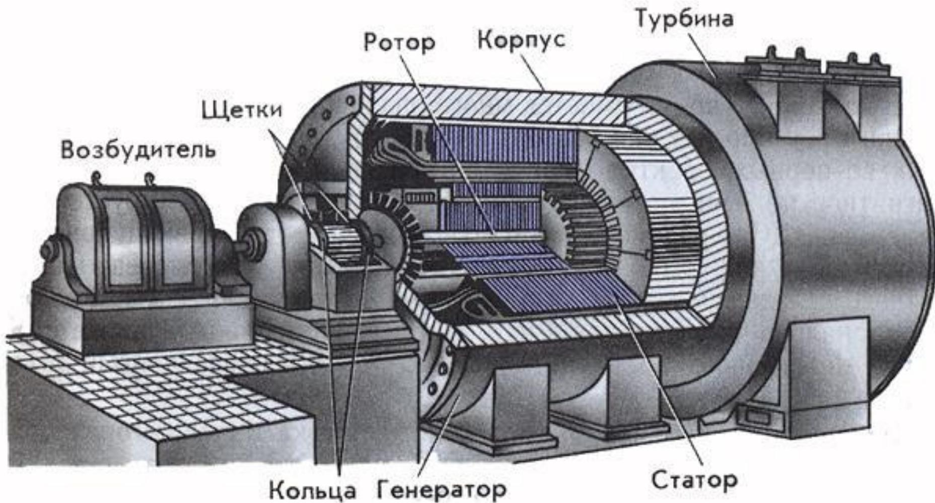
На тепловых электростанциях ротор генератора вращается с помощью паровой турбины, на гидроэлектростанциях с помощью водяной турбины.
