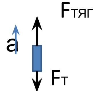
$$a = \frac{F_{\text{мяг}} - mg}{m}; a = \frac{660 \text{ Н} - 10 \text{ м/с}^2 \cdot 30 \text{ кг}}{30 \text{ кг}} = 12 \text{ м/с}^2$$
