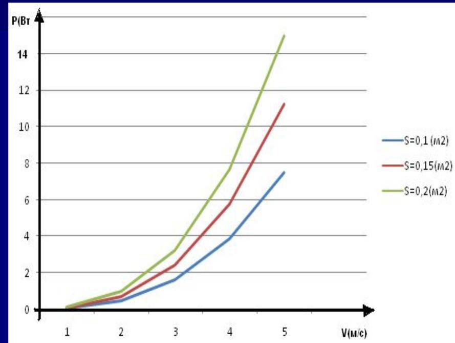
Для увеличения мощности (выходного напряжения) генератора необходимо увеличивать площадь лопастей ветряка этого можно добиться используя разные винты, которые в походных условиях не так трудно сделать из пустых пластиковых бутылок разной ёмкость..
