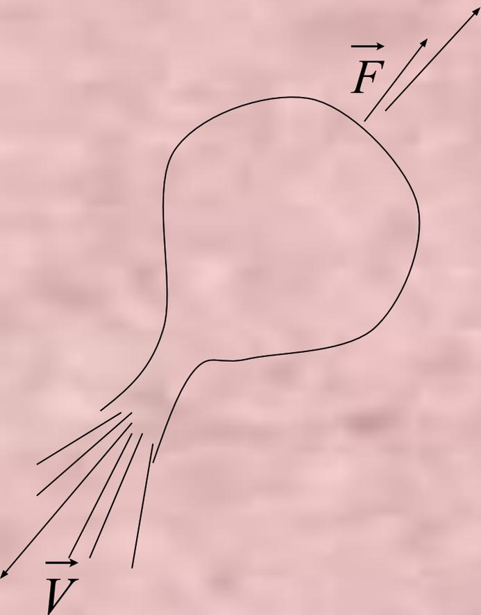
Под реактивным движением понимают движение тела, возникающее при отделении некоторой его части с определенной скоростью  $V$  относительно тела. Например, при истечении продуктов горения из сопла реактивного летательного аппарата. При этом появляется так называемая реактивная сила  $F$ , толкающая тело.
