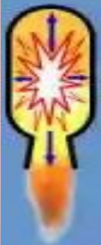
ПРИНЦИП РЕАКТИВНОГО ДВИГАТЕЛЯ
