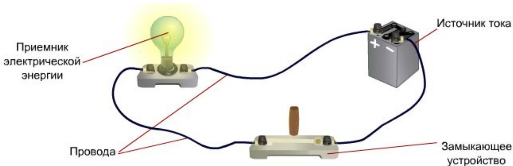
**Электрическая схема** – чертеж, на котором изображены способы соединения электрических приборов в цепь.
