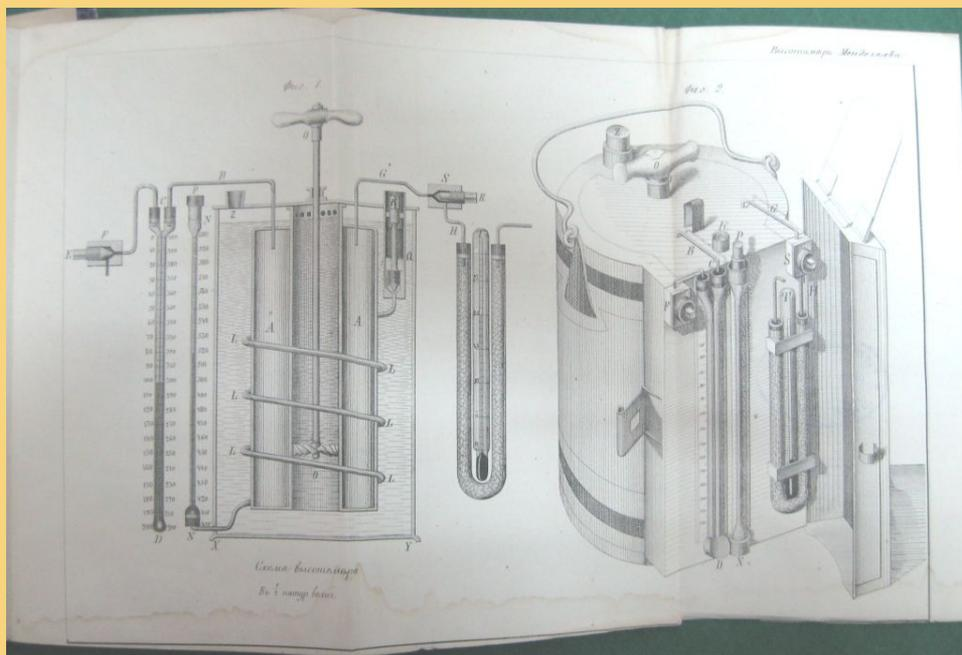
В 1876 году, исследуя упругость газов, Д. И. Менделеев изготовил чувствительный барометр, который он положил в основу высотомера, несколько образцов его было изготовлено и испытано офицерами генерального штаба, а вскоре было налажено их производство.
