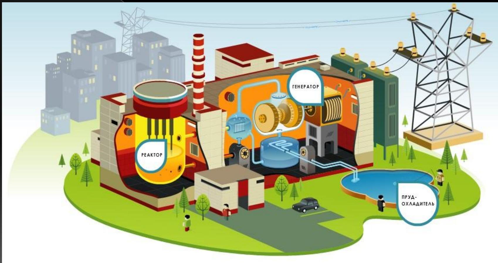
**АЭС** – тепловые электростанции, на которых в виде источника используется энергия управляемых ядерных реакций. Единичная мощность энергоблоков АЭС достигает **1,5 ГВт**.
