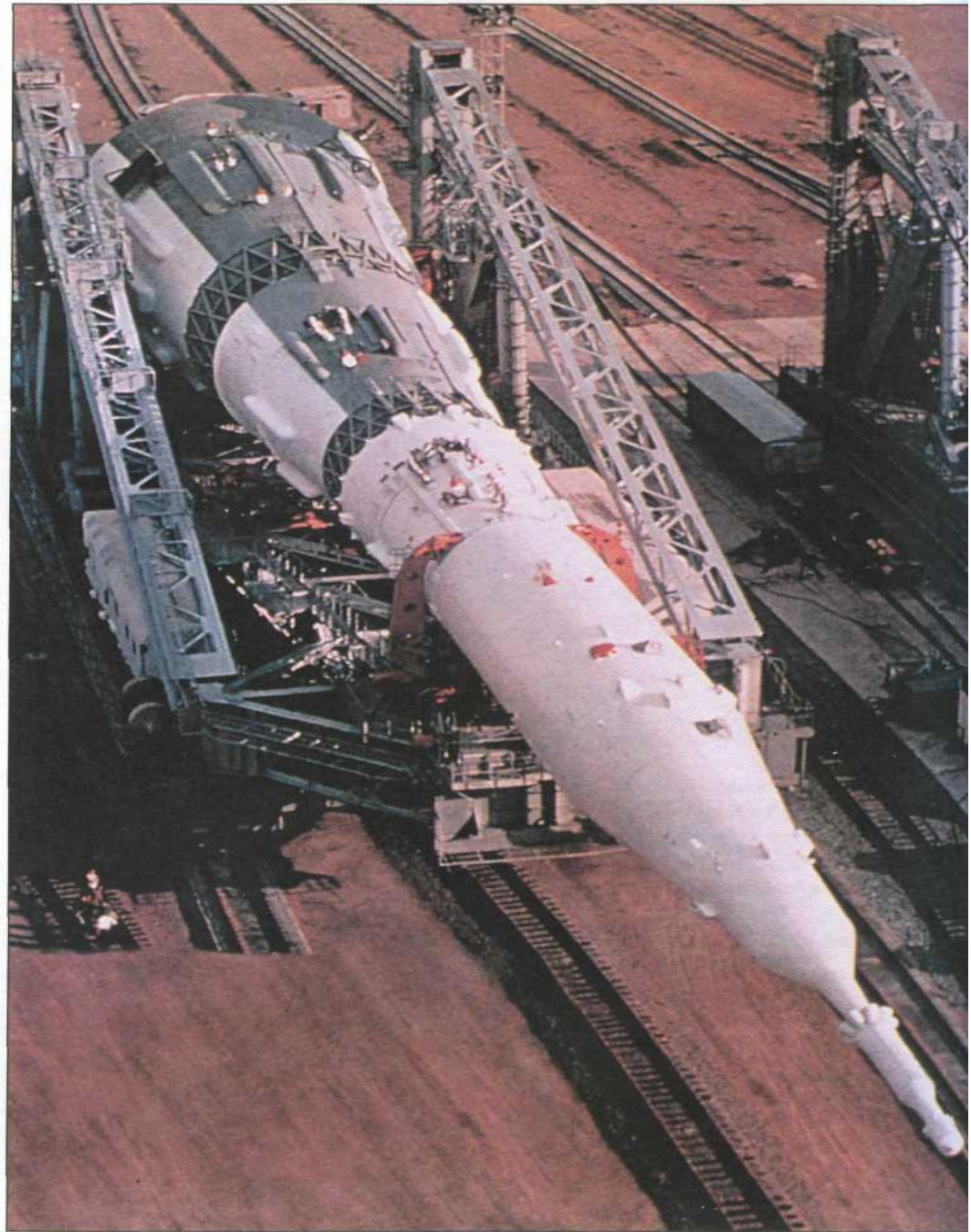
Ракету-носитель Н-1 вывозят на стартовую площадку в собранном виде. Там она поднималась в вертикальное положение с помощью специальной системы кранов.
