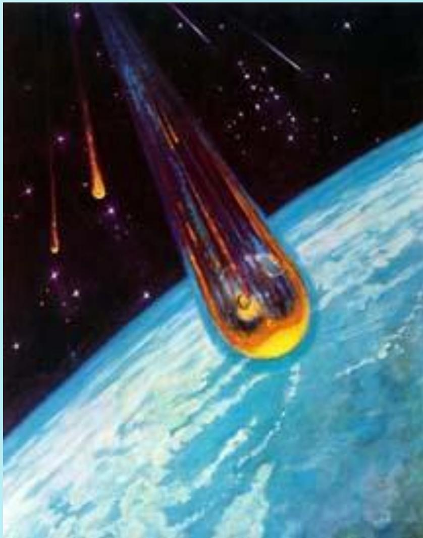
Космический корабль сошел со своей орбиты, выполняя последний этап полета - спуск на Землю. Атмосфера становится все более плотной. Со всех сторон корабль охватывают струи плазмы. Температура на поверхности капсулы повышается до 10 тысяч градусов - выше, чем на поверхности Солнца. Плавится и испаряется внешнее покрытие.
