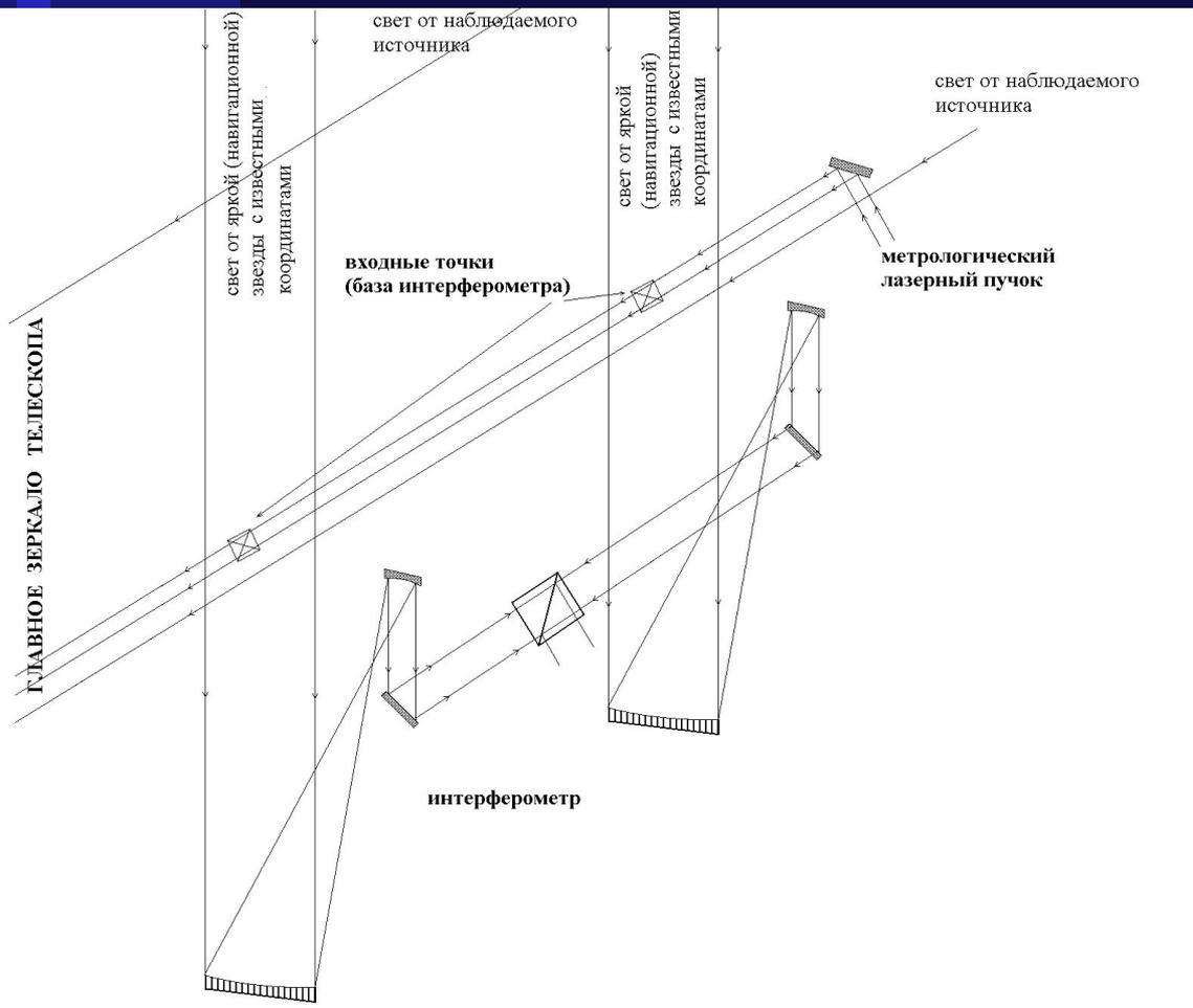
луч метрологического лазера, соединяющего концы базы, может быть использован как искусственная звезда с известными координатами
