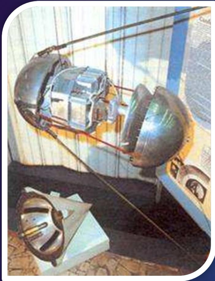
Внутри спутника решили разместить два радиопередатчика с частотой излучения 20,005 и 40,002 МГц. Прием их сигналов позволил бы ученым изучить условия прохождения радиоволн из космоса на Землю. Кроме того, надо было передавать и информацию о давлении и температуре внутри спутника.
