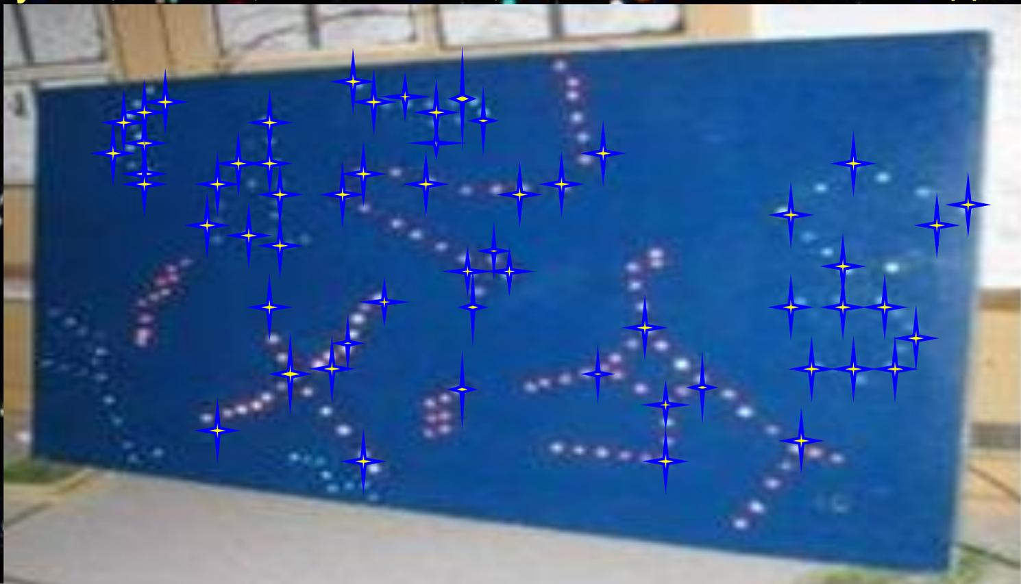
□ В качестве звезд мы решили использовать елочные гирлянды с автоматическим модулем управления. В гирлянде 4 автоматически переключающихся линии разных цветов. Каждая линия рассчитана на 48 светодиодов и соединена параллельно с остальными.
