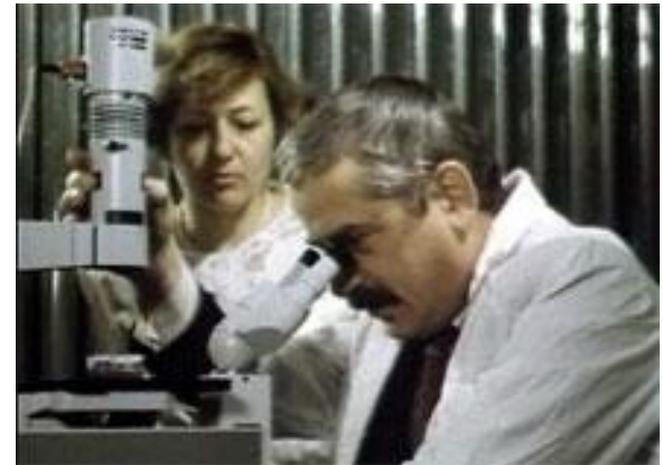
инструмент, позволяющий получать увеличенное изображение мелких объектов и их деталей, не видимых невооруженным глазом. Увеличение микроскопа, достигающее 1500-2000, ограничено дифракционными явлениями.
