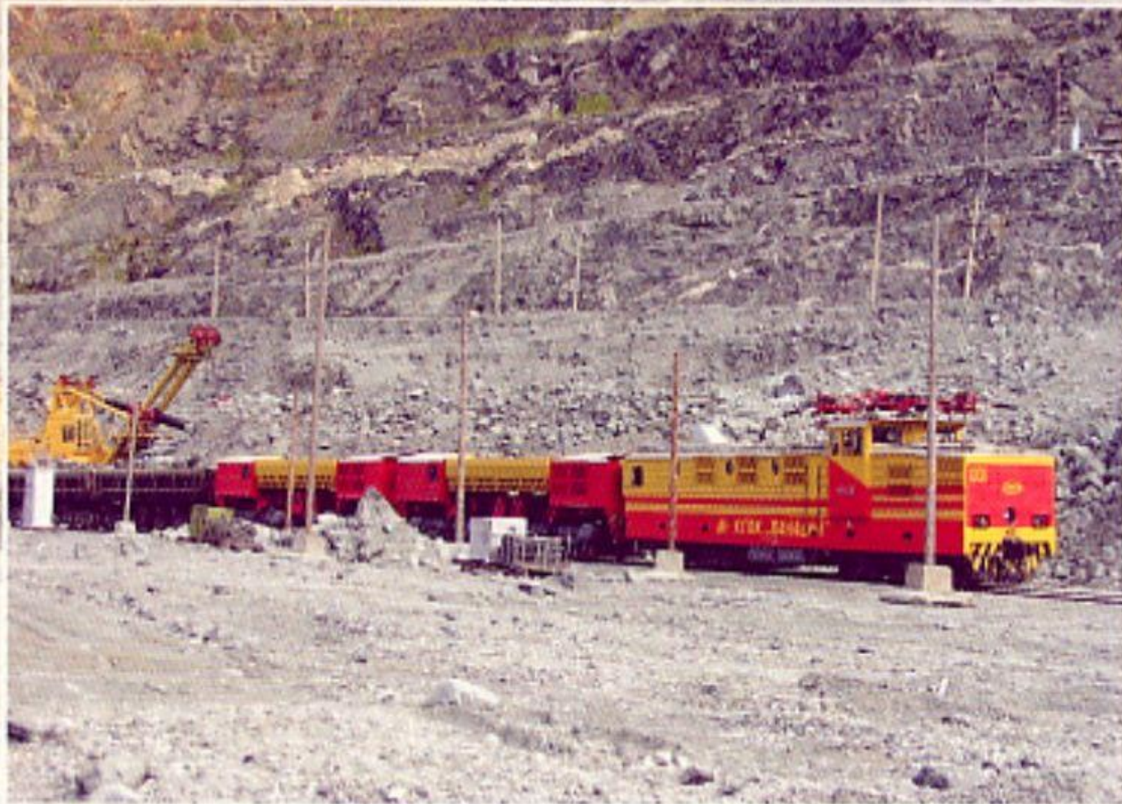
Вывоз горной массы тяговым агрегатом НП-1
