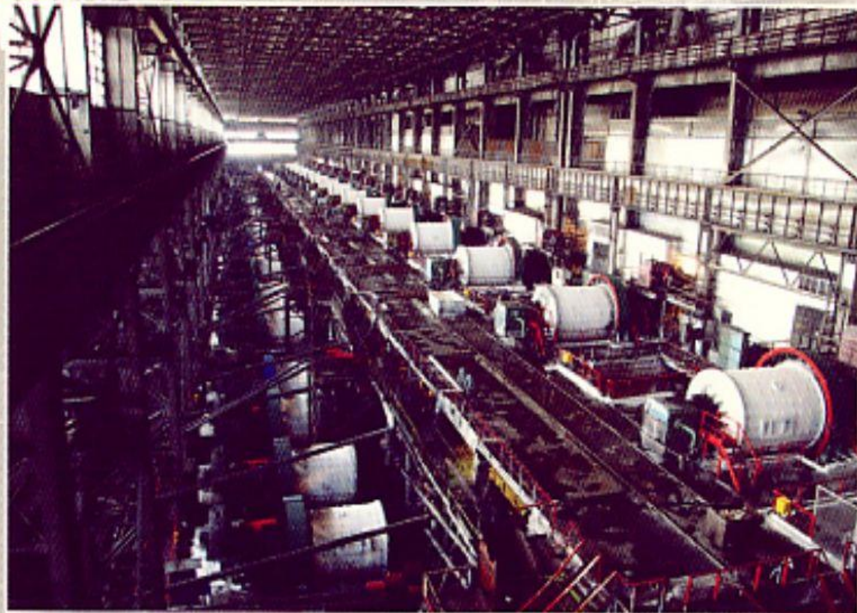
Мельничный пролет цеха обогащения обогатительной фабрики
