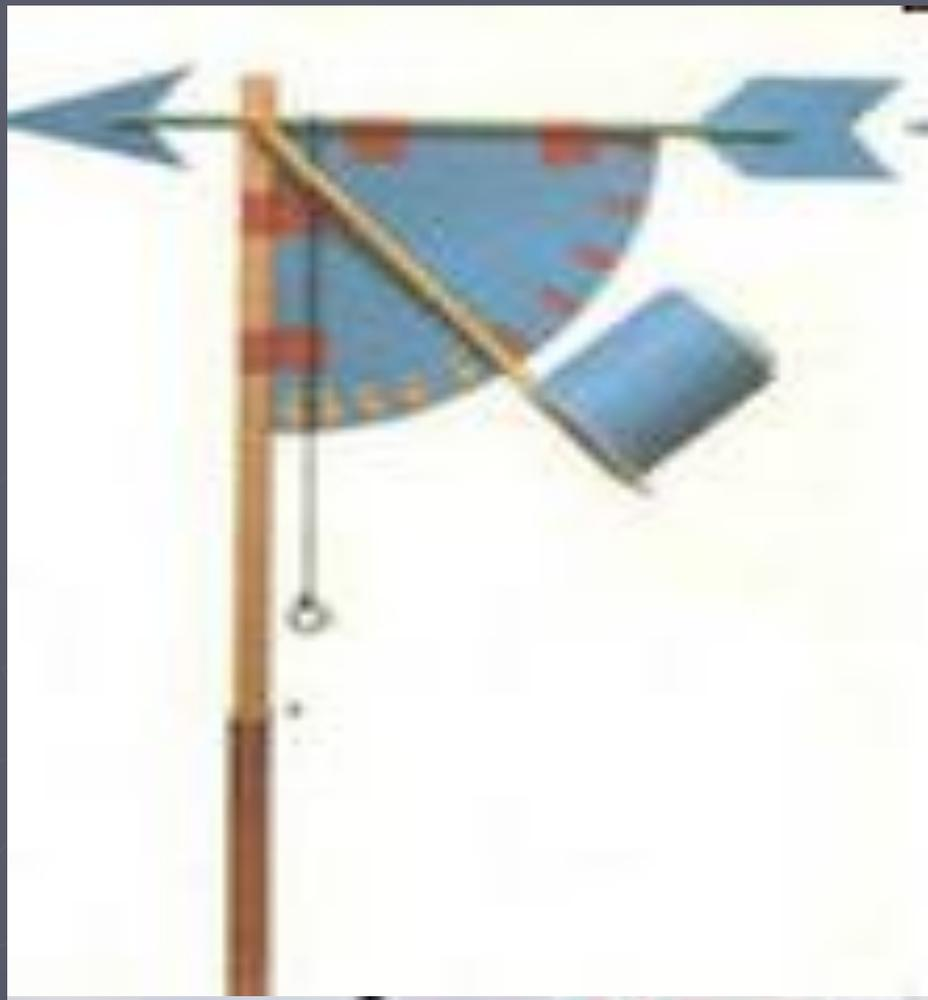
Анемометр-прибор для измерения скорости ветра
