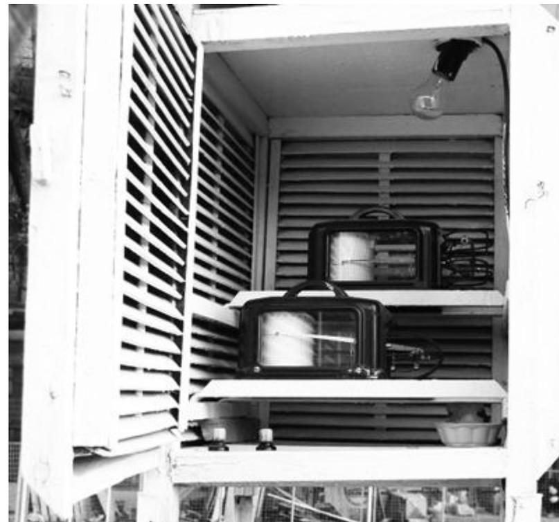
Так, например, если по сухому температура  $7,2\text{ }^{\circ}\text{C}$ , а по смоченному  $6,5\text{ }^{\circ}\text{C}$ , то точка росы —  $5,6\text{ }^{\circ}\text{C}$ , абсолютная влажность —  $9,1\text{ гПа}$ , относительная —  $90\%$ , а дефицит насыщения —  $1,1\text{ гПа}$ .
