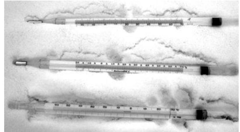
Максимальный, минимальный и срочный напочвенные термометры на поверхности снега
