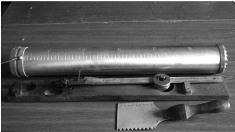
**Снегомер** - предназначен для измерения высоты и массы вырезаемого столбика пробы снега.
