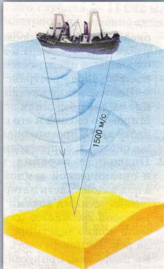
Измерение глубин эхолотом
