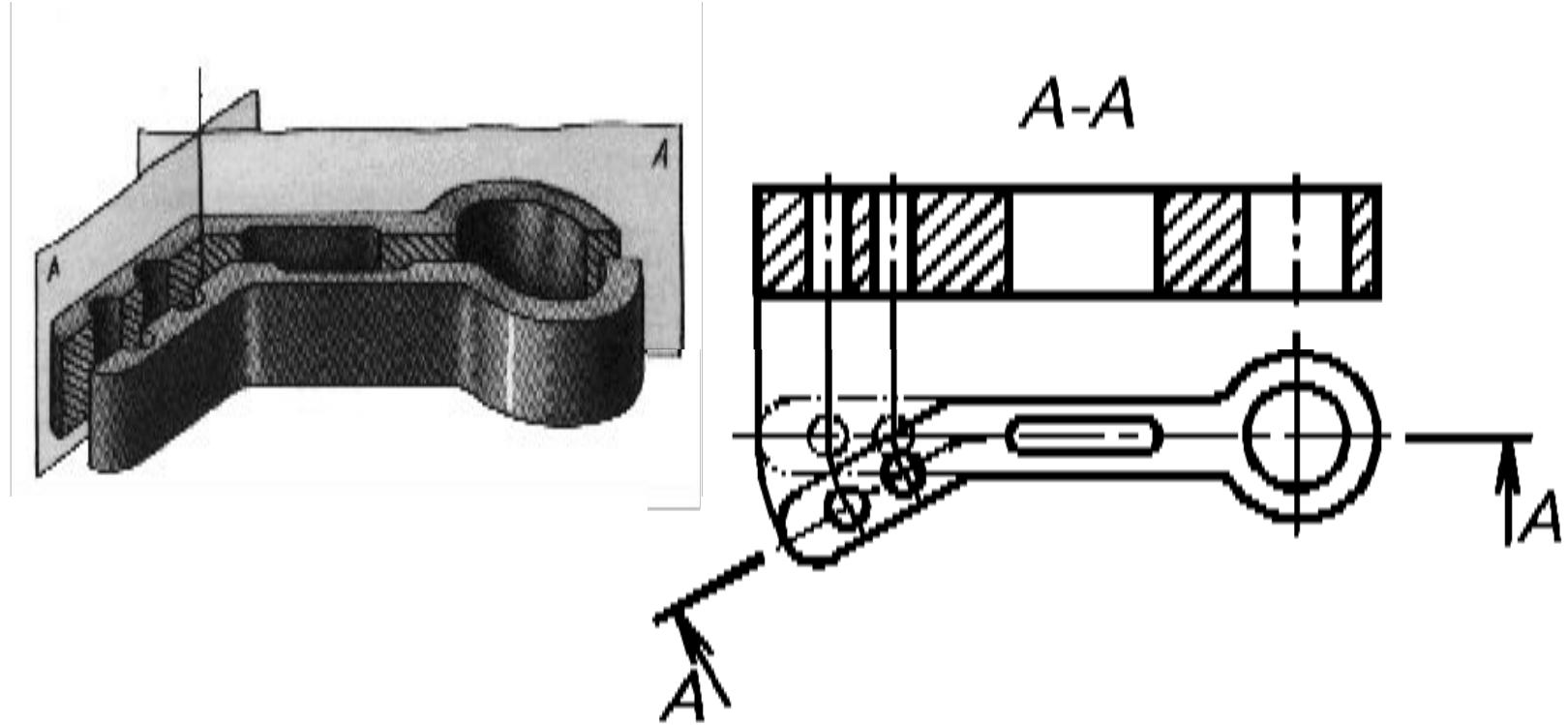
При ломанных разрезах секущие плоскости условно поворачивают до совмещения в одну плоскость
