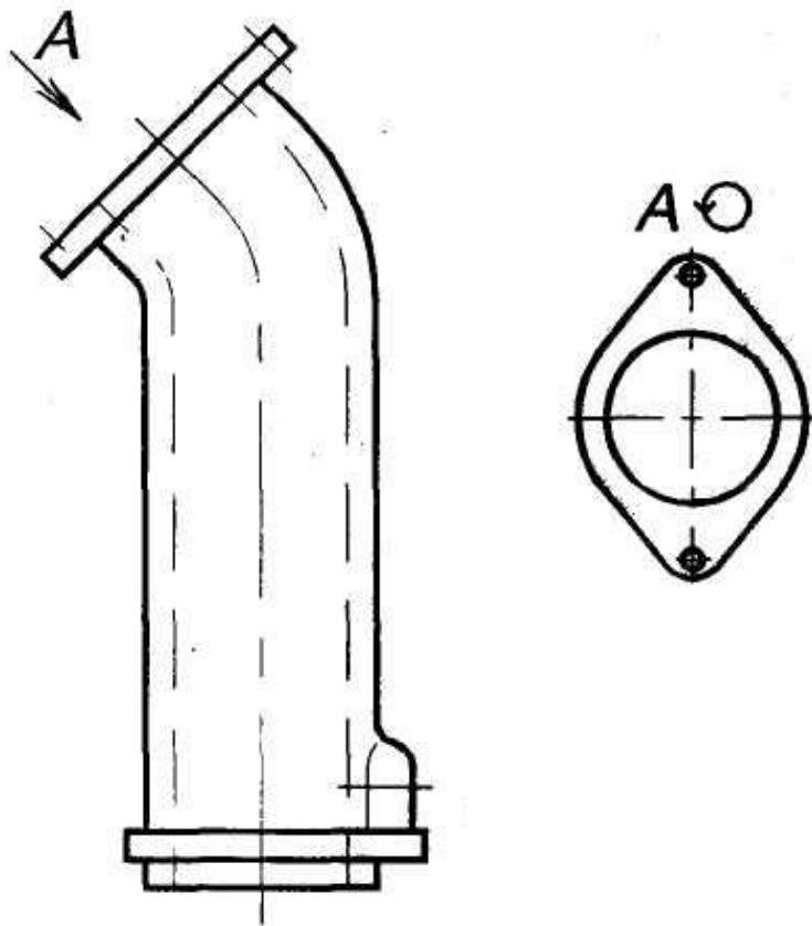
Для удобства чтения чертежа дополнительный вид допускается поворачивать, при этом к надписи должен быть добавлен знак, заменяющий слово «поворнуто».
