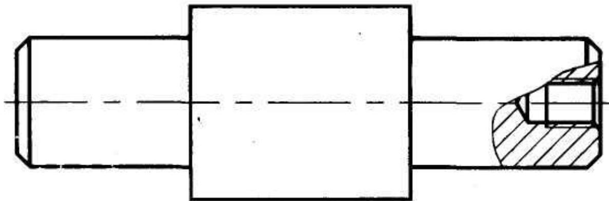
Если местный разрез выполнен на виде, то его **не обозначают**.
