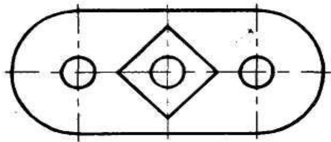
Если соединяется половина вида и половина разреза, каждый из которых является **симметричной** фигурой, то разделяющей линией служит ось симметрии.
