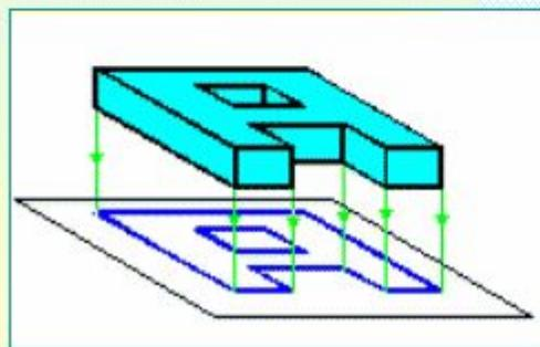
В методе прямоугольного проецирования проецирующие лучи перпендикулярны плоскости проекций, и плоскости проекций перпендикулярны между собой
