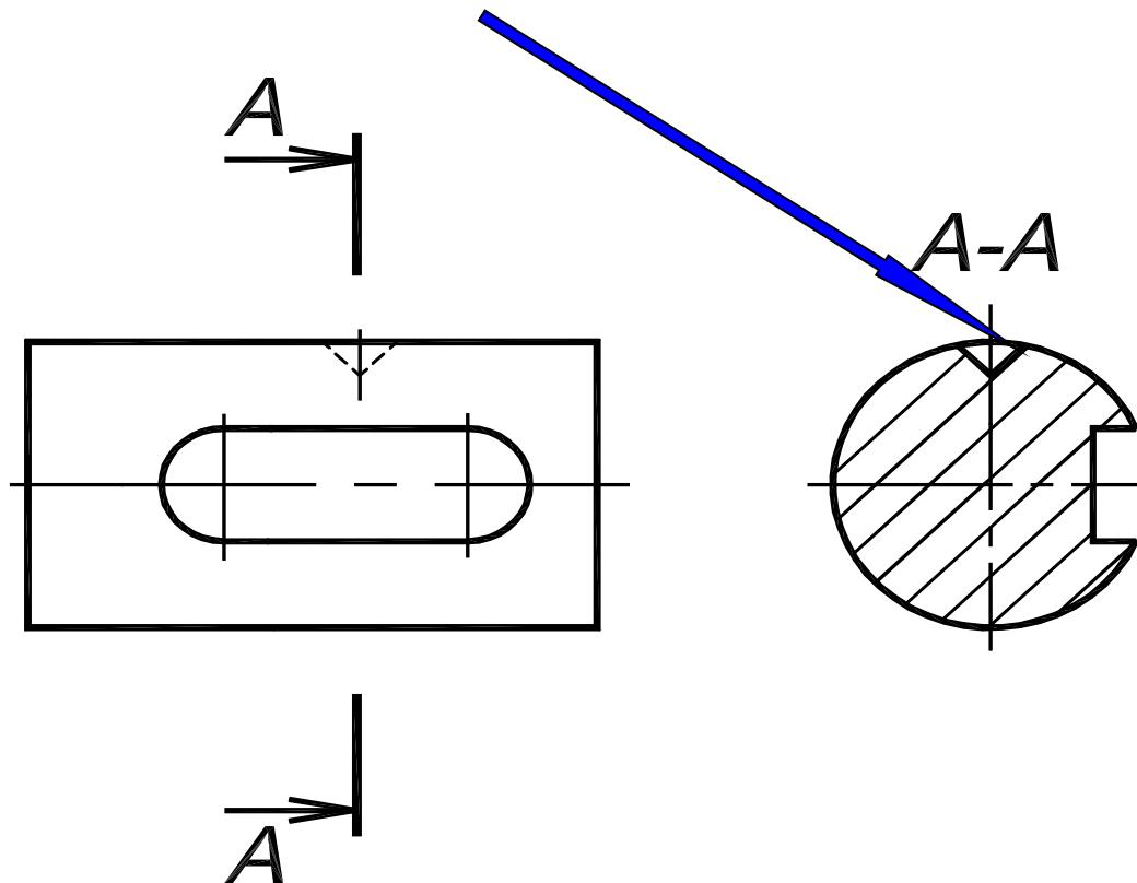
**2. Если сечение распадается на отдельные части, то его заменяют разрезом.**
