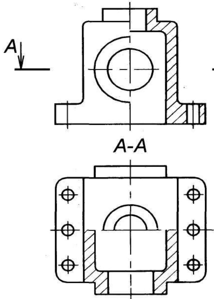
При соединении части (половины) вида с частью (половиной) разреза обозначение наносят по общим правилам обозначения простых разрезов.
