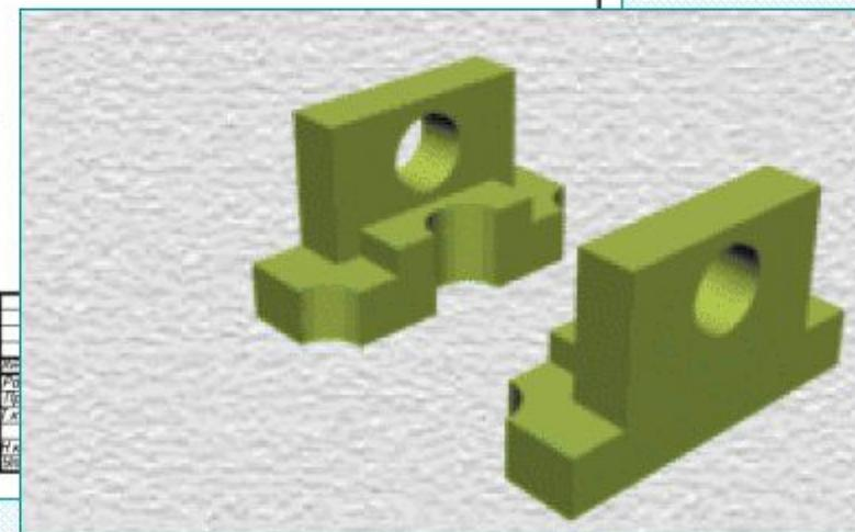
Рациональнее для данной детали дать на фронтальной плоскости проекций изображение половины вида с половиной разреза, т.к. и вид, и разрез являются фигурами симметричными.
