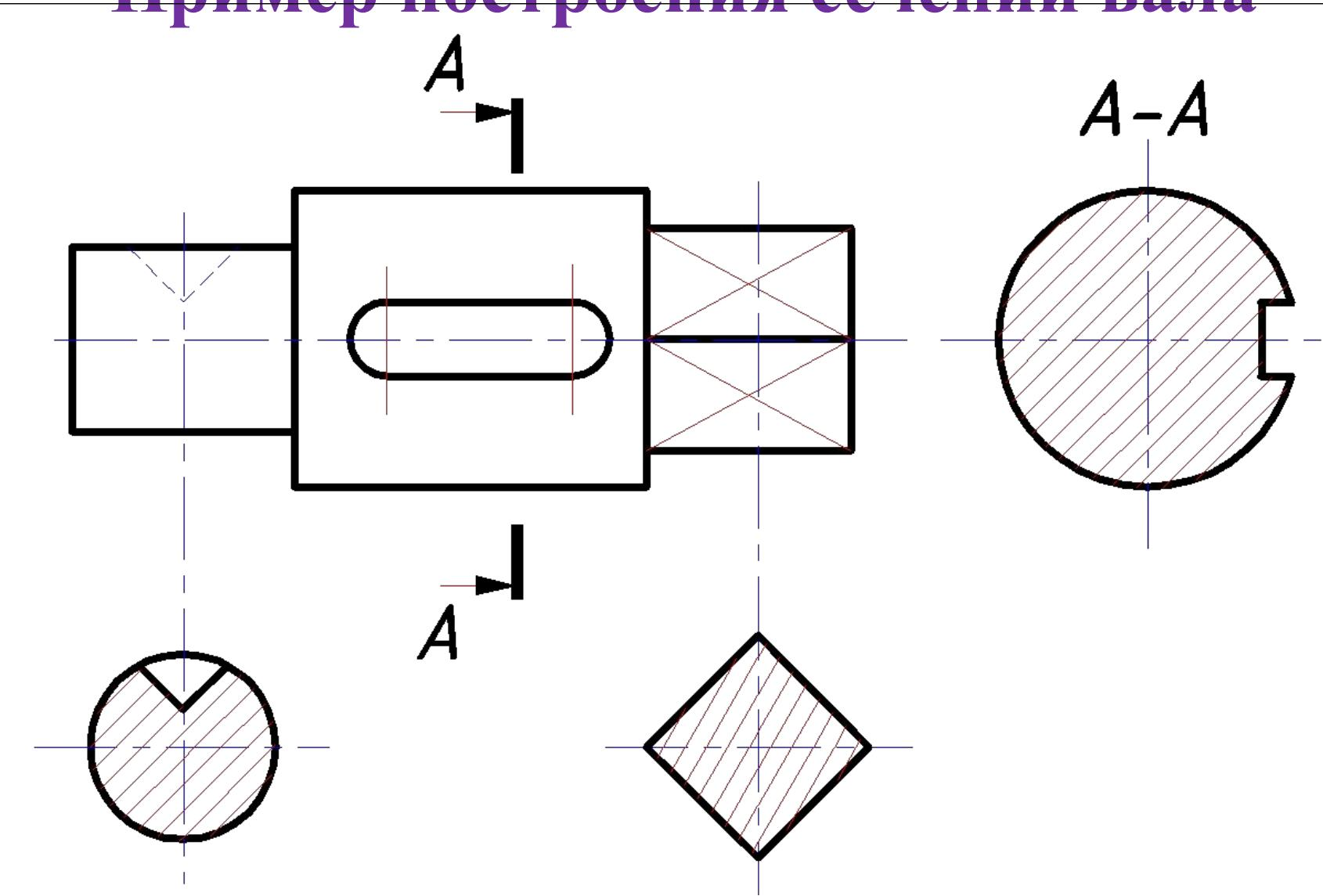
Наносим обозначение сечения с односторонним пазом.
