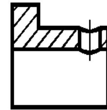
Секущая плоскость - **профильная** плоскость уровня (проходящая через ось симметрии детали).
