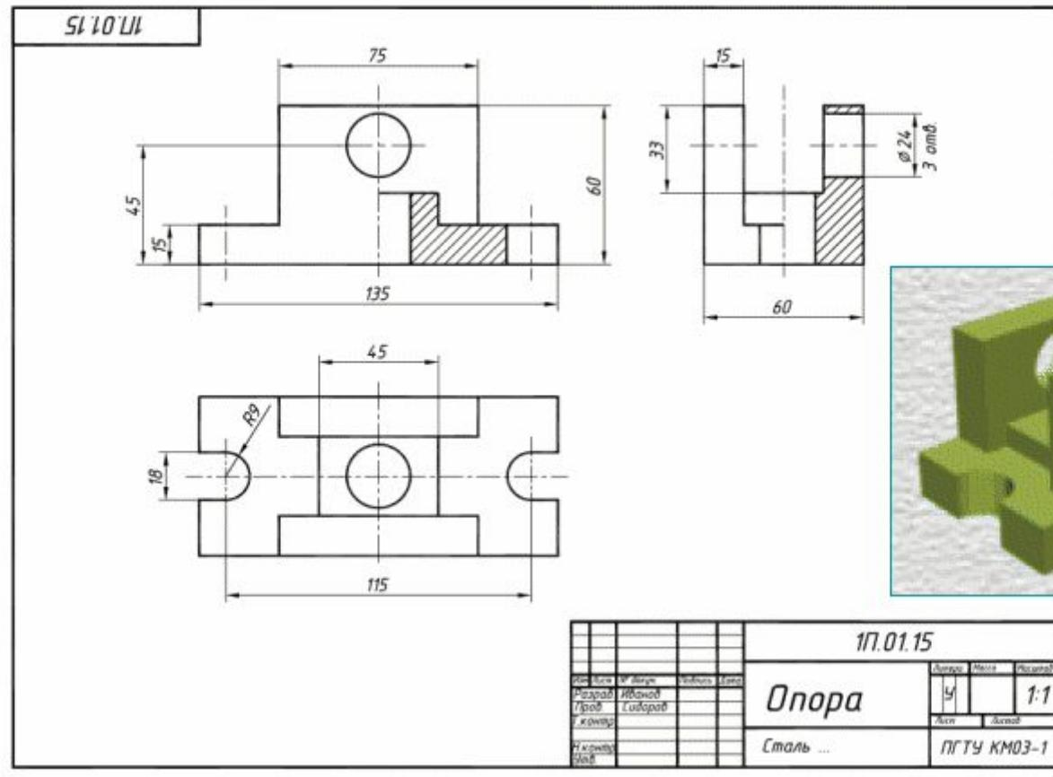
Дополним чертеж простановкой размеров и оформлением основной надписи.
