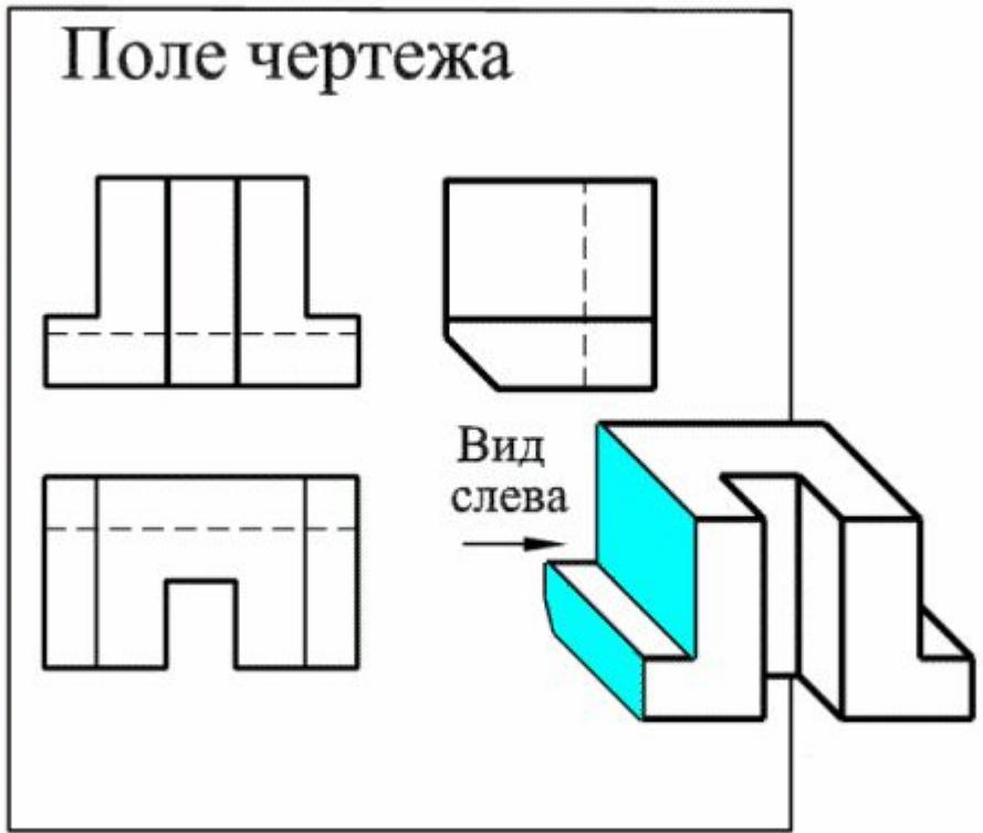
На профильной плоскости проекций следует выполнить вид слева, т.к. на нем виден угол среза детали. Рациональнее выполнить его в проекционной связи с видами спереди и сверху.
