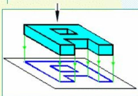
Наблюдатель видит одновременно и предмет, и плоскость, на которой предмет отображается
