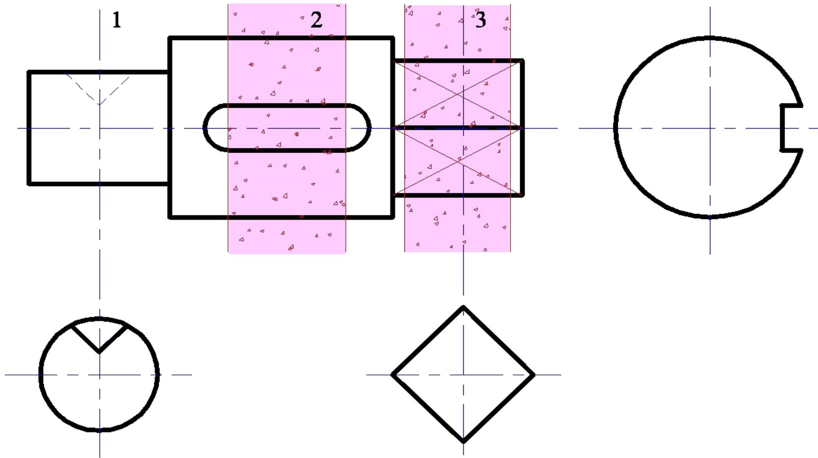
Выбираем места рационального расположения сечений: симметричные относительно следа секущей плоскости – на продолжении этого следа (штрих - пунктирная линия), несимметричное – в любом месте поля чертежа. Строим контуры сечений.
