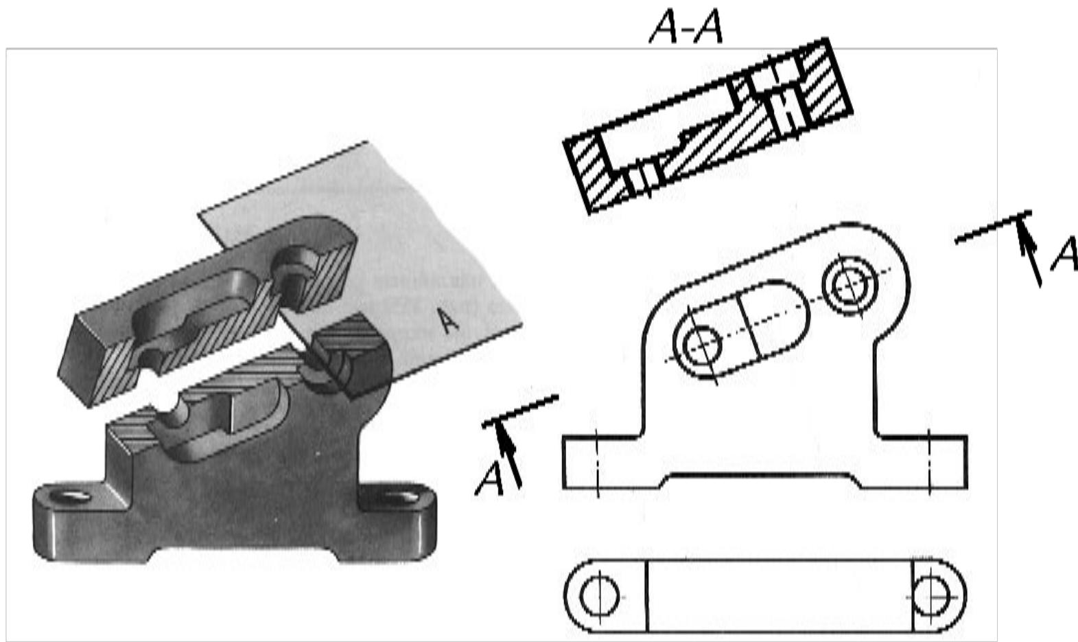
При получении наклонных разрезов секущая плоскость составляет с горизонтальной плоскостью угол, отличный от прямого угла. Наклонные разрезы **обозначают всегда**.
