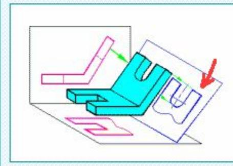
Дополнительная плоскость расположена под углом к горизонтальной плоскости проекций отличным, от 90 градусов.
