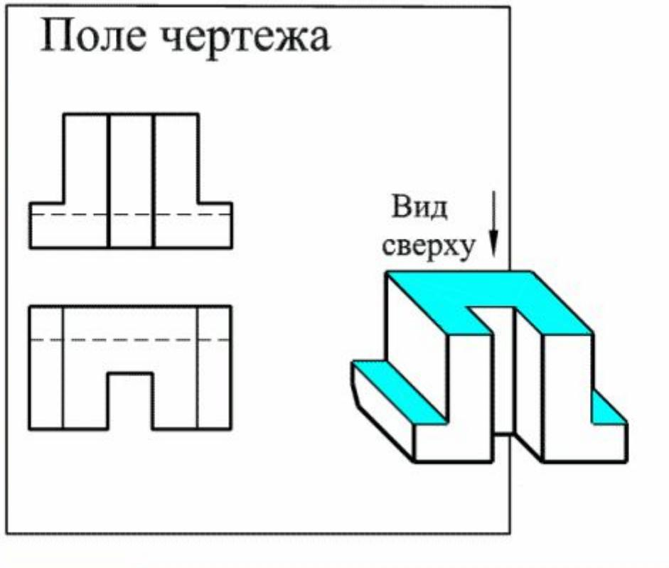
Вид сверху строится на горизонтальной плоскости проекций. Он определяет глубину сквозного паза и третье габаритное измерение. Выполняется в проекционной связи с главным видом.
