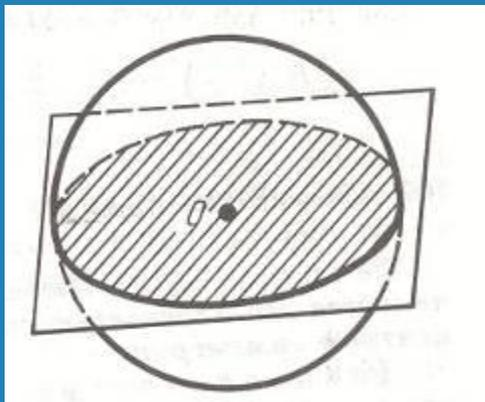
Сечение шара диаметральной плоскостью называется большим кругом.
