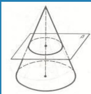
Сечение конуса плоскостью, параллельной его основаниям, представляет собой круг с центром на оси конуса.
