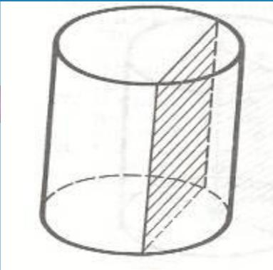
Сечение цилиндра плоскостью, параллельной его оси, представляет прямоугольник.
