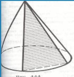
Сечение конуса плоскостью, проходящей через его вершину, представляет собой равнобедренный треугольник.
