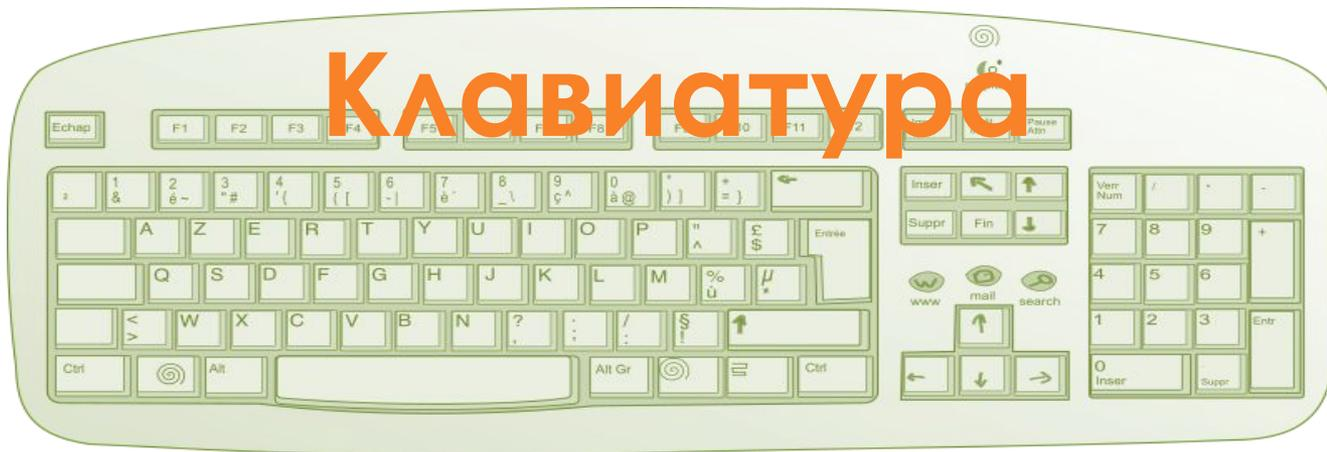
Нужна для ввода информации в ПК, ввода команд и навигации внутри некоторых программ. Содержит набор клавиш для ввода текстов и некоторые дополнительные функциональные клавиши, плюс - малую цифровую клавиатуру.
