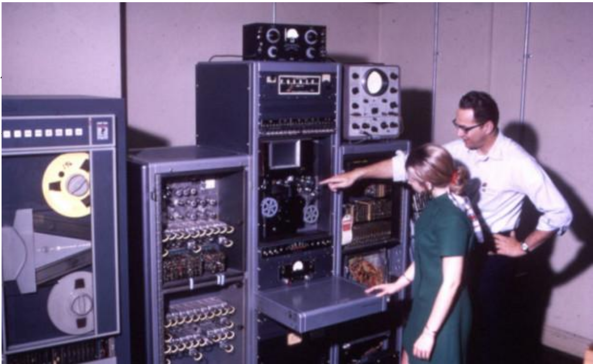
(Лос-Анджелес). Компьютер Honeywell DP-516 имел 24 Кб оперативной памяти.
