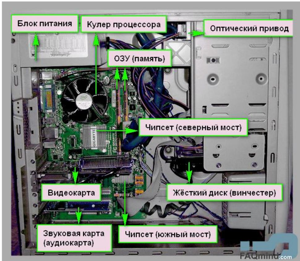
**Блок питания:** обеспечивает питание всем частям компьютера.
