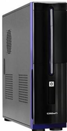
**Mini-Tower** — имеют относительно невысокий корпус, предназначенный в основном для установки его на столе в вертикальной позиции.
