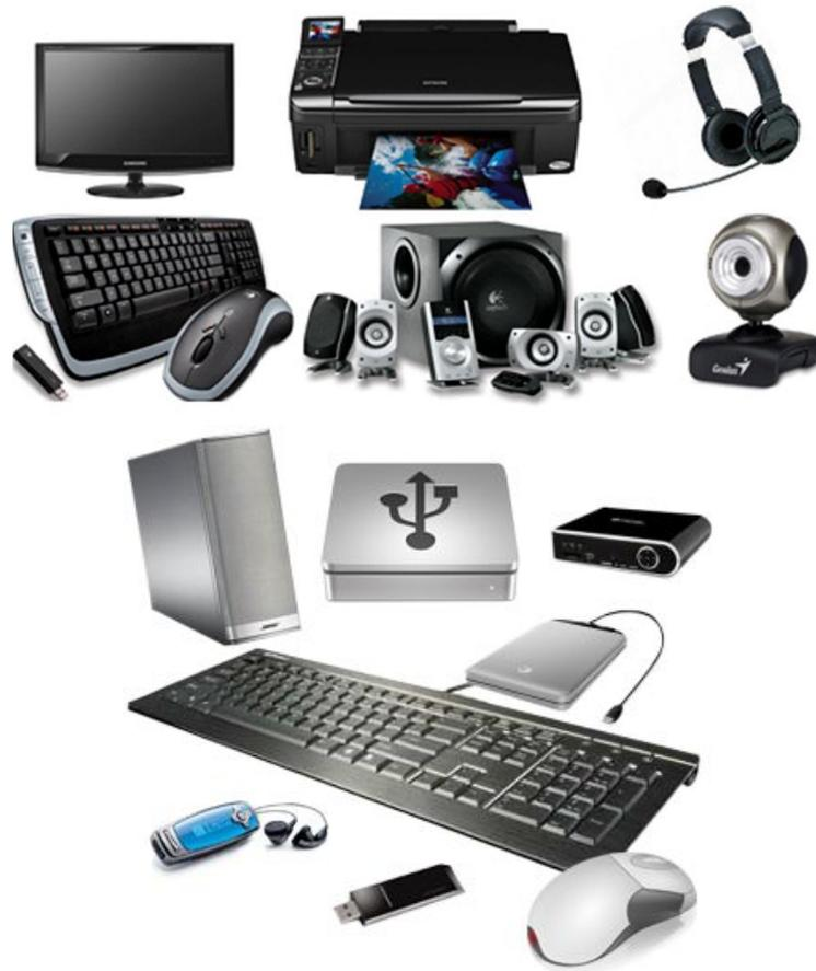
**Периферийные устройства персонального компьютера** - это клавиатура, манипулятор «мышь», монитор, принтер, жесткий диск, привод CD-/DVD- дисков, модем, сетевая карта (для подключения к сети Интернет), видеочамера, сканер и т. п. Несмотря на великое многообразие периферийных устройств ПК, все они взаимодействуют с процессором и оперативной памятью примерно одинаковым образом, о чем будет сказано далее.
