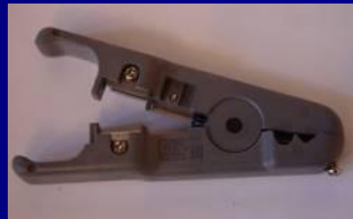
Нож для зачистки изоляции витой пары
