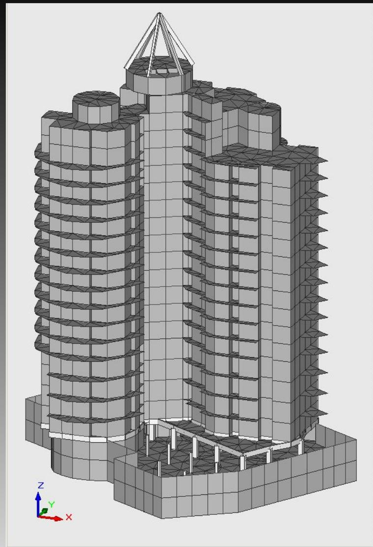
Схемы сооружений, расчет которых можно выполнить с помощью **SCAD Middle**
