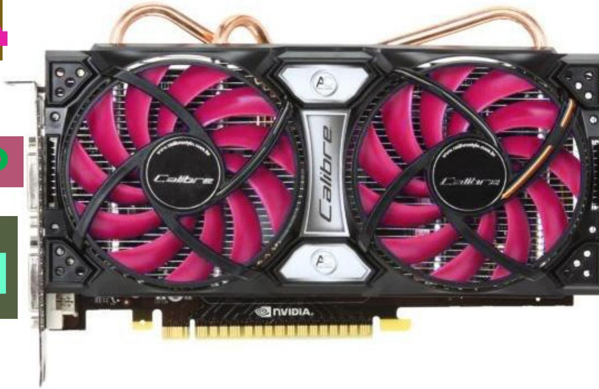
графический образ, хранящийся как содержимое памяти компьютера или самого адаптера, в иную форму, предназначенную для дальнейшего вывода на экран
