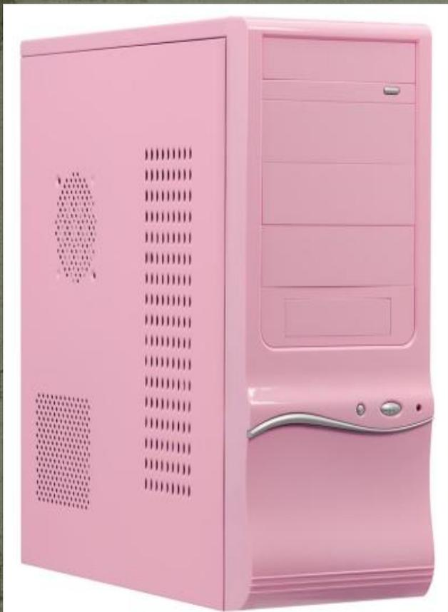
Системный блок (сленг. системник, кейс, корпус) — функциональный элемент, защищающий внутренние компоненты компьютера от внешнего воздействия и механических повреждений, поддерживающий необходимый температурный режим внутри, экранирующий создаваемые внутренними компонентами электромагнитное излучение и являющийся основой для дальнейшего расширения системы. Системные блоки массово изготавливают заводским способом из деталей на основе стали, алюминия и пластика.
