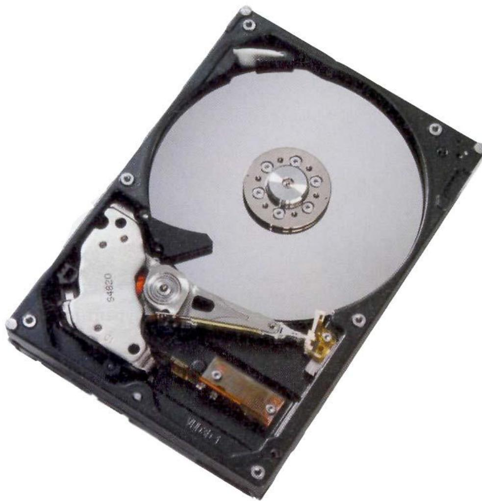
Внутри корпуса размещаются носитель информации а также магнитные головки и устройство позиционирования
