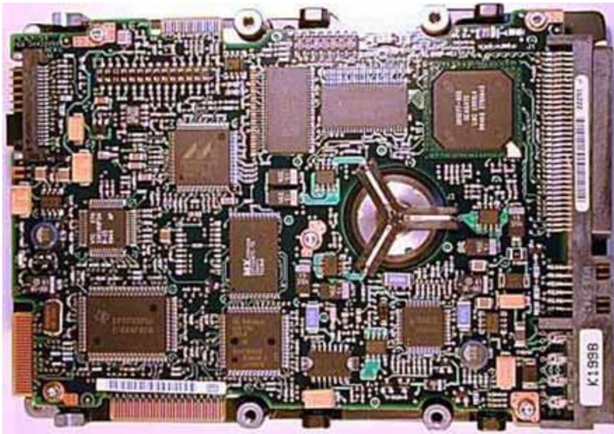
Снизу на корпусе прикреплена печатная плата, представляющая собой встроенный контроллер жесткого диска, который необходим для обеспечения его нормальной работы
