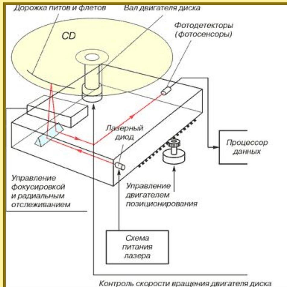
*Схема устройства лазерного дисковода*
