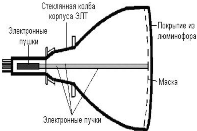
Основной элемент дисплея — электронно-лучевая трубка. Её передняя, обращенная к зрителю часть с внутренней стороны покрыта люминофором — специальным веществом, способным излучать свет при попадании на него быстрых электронов.
