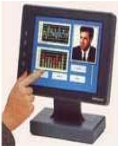
Общение с компьютером осуществляется путём прикосновения пальцем к определённому месту чувствительного экрана. Этим выбирается необходимый режим из меню, показанного на экране монитора. (Меню — это выведенный на экран монитора список различных вариантов работы компьютера, по которому можно сделать конкретный выбор.) Сенсорными экранами оборудуют рабочие места операторов и диспетчеров, их используют в информационно-справочных системах и т.д.
