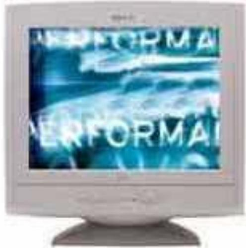
Подавляющее большинство мониторов сконструированы на базе электронно-лучевой трубки (ЭЛТ), и принцип их работы аналогичен принципу работы телевизора. Мониторы бывают алфавитно-цифровые и графические, монохромные и цветного изображения. Современные компьютеры комплектуются, как правило, цветными графическими мониторами.
