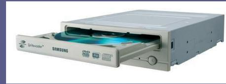
Привод CD/DVD : служит для чтения лазерных цифровых, аудио и видео дисков
