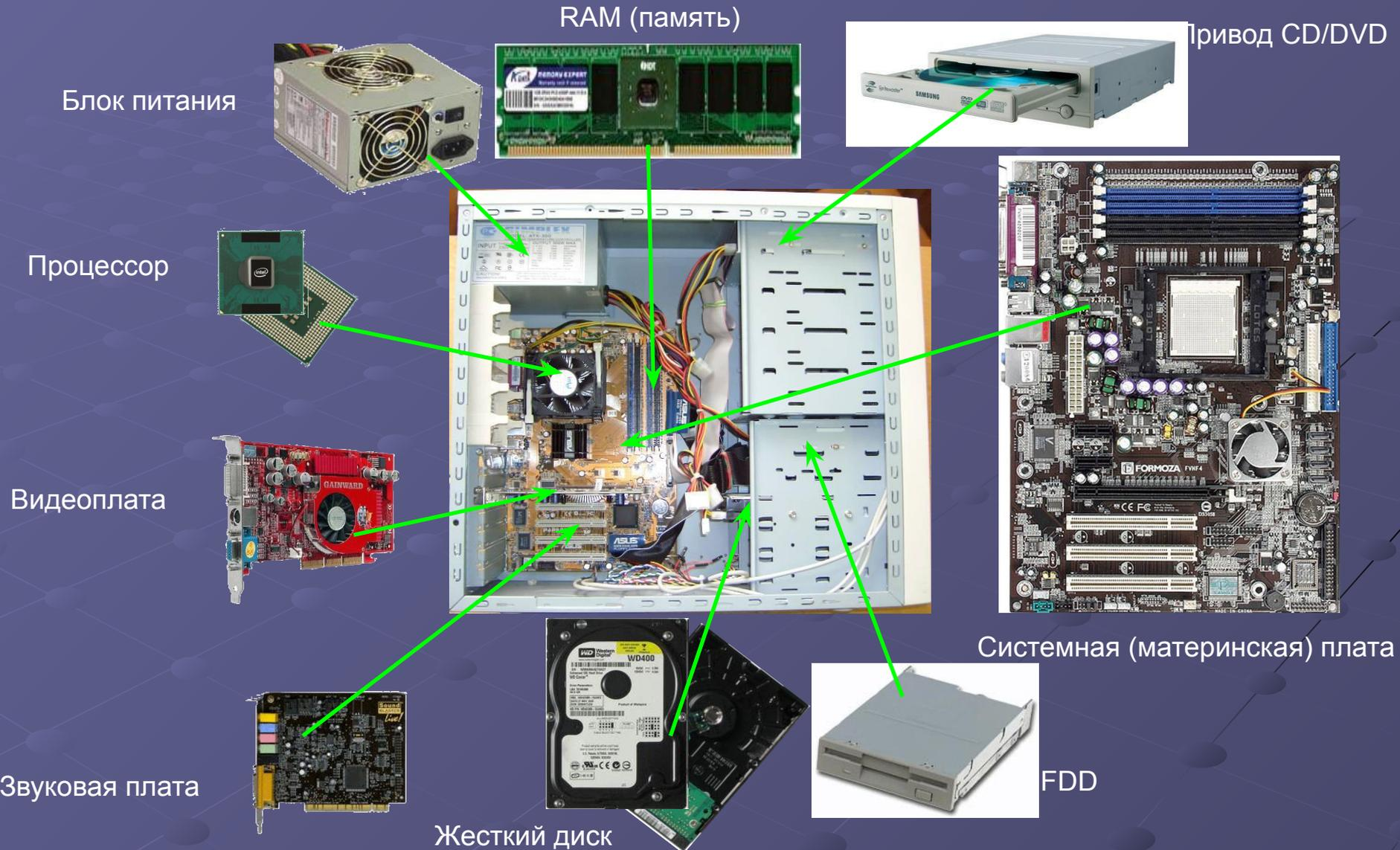
Процессор: управляет работой компьютера, выполняет вычисления
