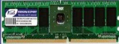
RAM (память) используется для размещения работающей программы и данных, с которыми работает программа (текст, изображение, звук и др.)
