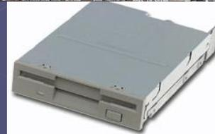
FDD: устройство для сохранения и переноса информации между компьютерами при помощи гибких магнитных дисков
