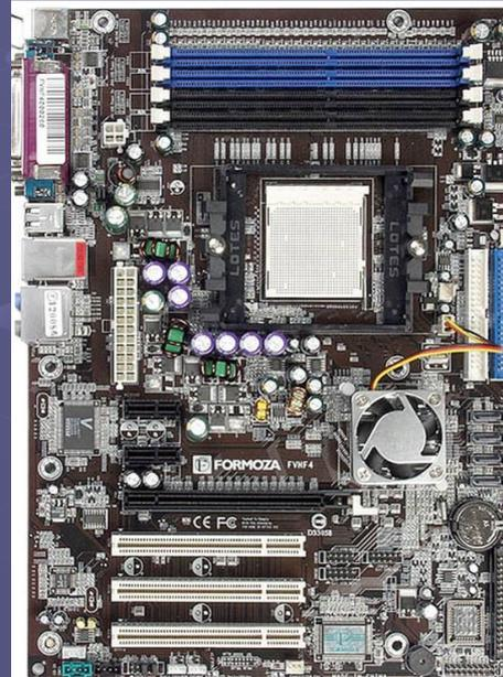
Системная (материнская) плата: предназначена для размещения на ней или подключения к ней с помощью специальных разъемов других компонентов. Обеспечивает их взаимодействие
