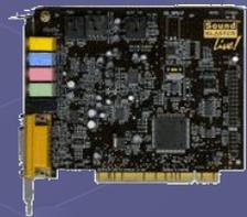
Звуковая плата: служит для создания и обработки звука и вывода его на головные телефоны или колонки.
