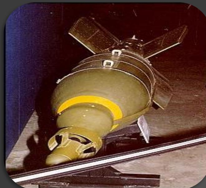
[BOLT-117](#) одна из первых бомб с лазерным наведением
