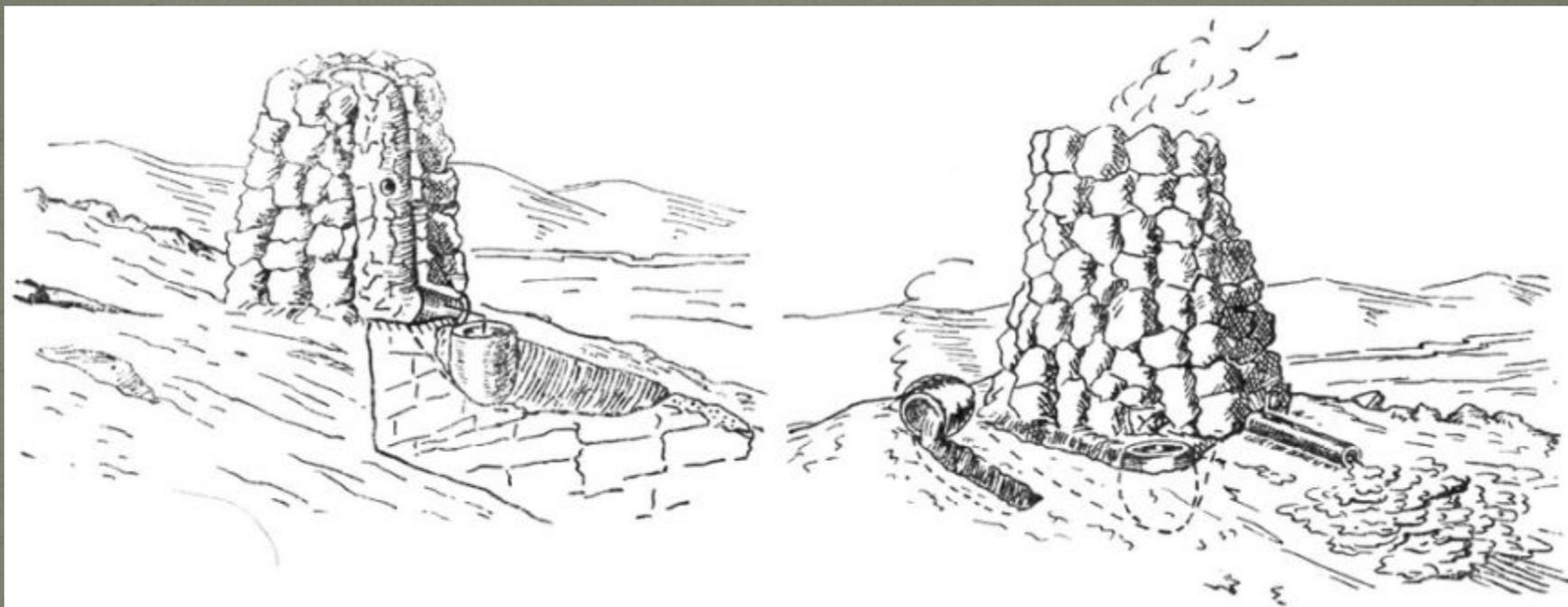
Реконструкция плавильных печей на горе Думной:
