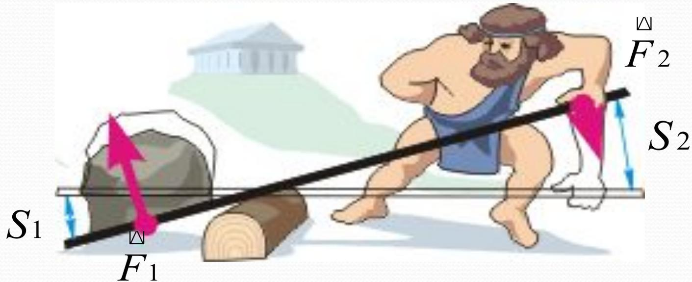
При использовании рычага выигрыша в работе не получают
