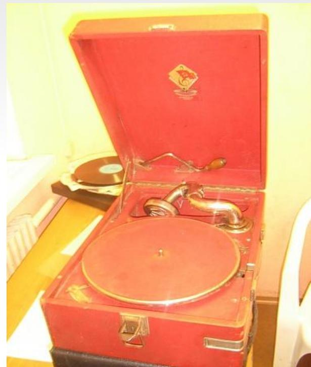
При проигрывании патефонных пластинок применялась сапфировая игла, рассчитанная на многократное использование, в отличие от граммофонной стальной иглы. Важное различие патефонных и граммофонных пластинок состоит в том, что направление канавки патефонной пластинки изнутри к краю, а граммофонной - от края к центру. Таким образом, на настоящем патефоне невозможно прослушать граммофонную пластинку (и наоборот).
