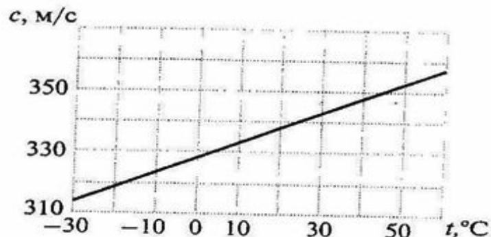
*При повышении температуры воздуха на 1°C скорость звука в нем увеличивается на 0,59 м/с. При  $t = -100^\circ\text{C}$  скорость звука равна 263,7 м/с, а при  $t = 500^\circ\text{C}$  увеличивается до 557,3 м/с.*
