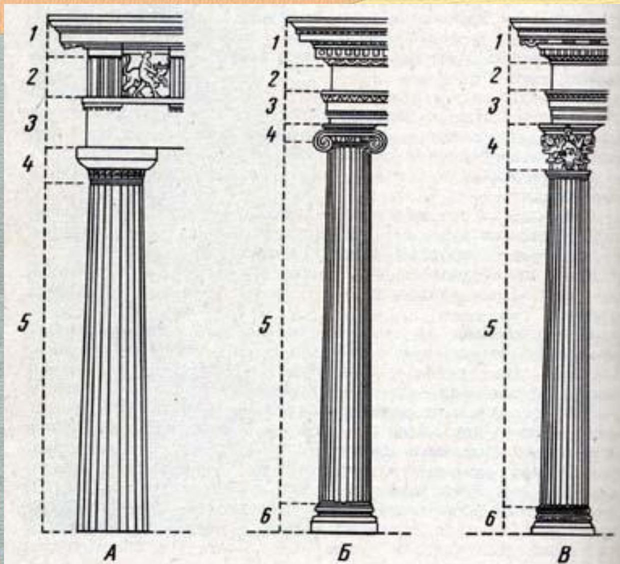
Цифрами показаны части ордера: 1 – карниз, 2 – фриз, 3 – архитрав (карниз, фриз и архитрав вместе образуют антаблемент), 4 – капитель, 5 – ствол колонны, 6 – база.
