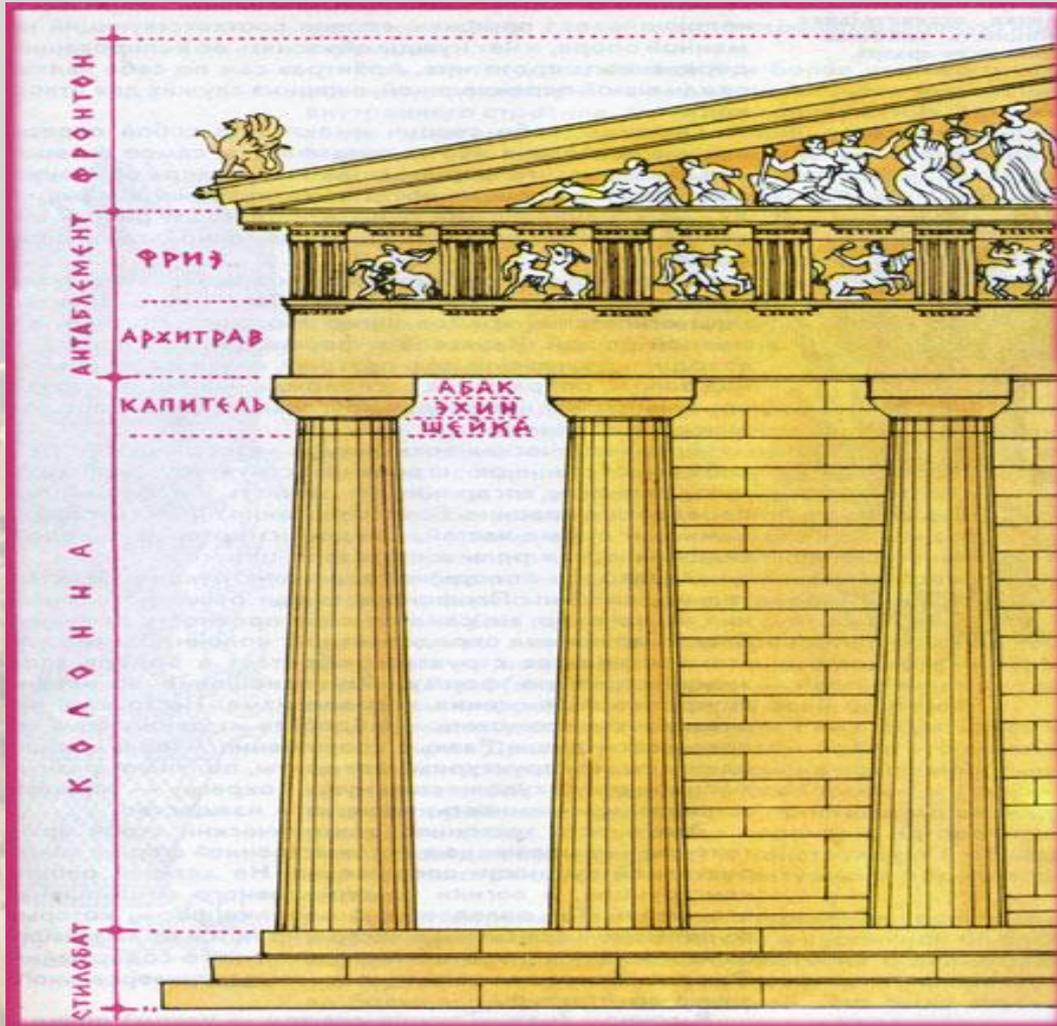
**Ордер** – порядок расположения архитектурных элементов здания в зависимости от характера сооружения.
