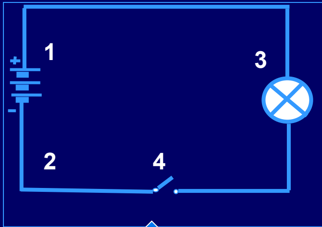
Схема электрической цепи
