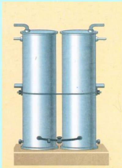
Вертикальный бак аварийного запаса воды
