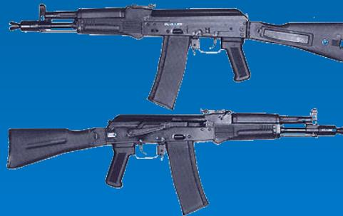
Приняв за основу АК74, установили длину ствола, при которой начальная скорость 5,45-мм пули равнялась скорости 7,62-мм пули при выстреле из АКМ.
