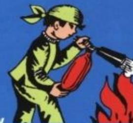
**3** Сжать рукоятку запорно-пускового устройства.
