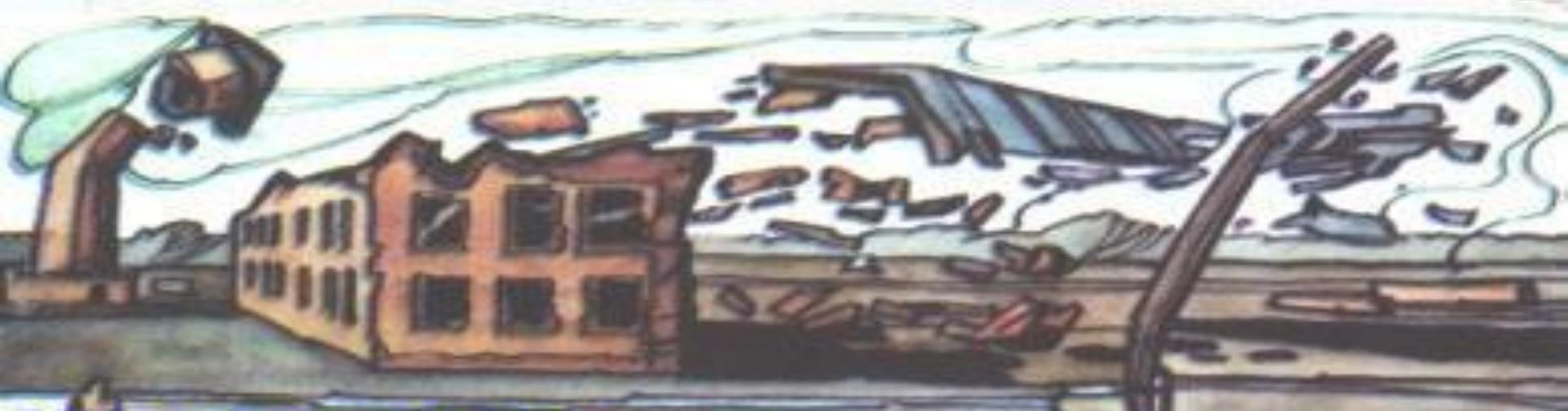
• Воздушной ударной волной называется область резкого сжатия воздуха, распространяющаяся во все стороны от центра взрыва со сверхзвуковой скоростью. Переднюю границу волны, характеризующуюся резким скачком давления, называют фронтом ударной волны.
