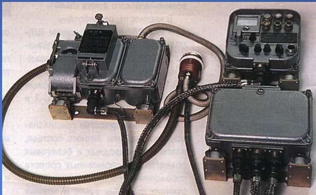
ИЗДЕЛИЕ ПРХР (прибор радиационной, химической разведки) - газосигнализатор-дозиметр обеспечивает измерение мощности гамма-излучения в диапазоне 0,2-150 Р/ч, а также наличие специальных веществ в воздухе. Индикация - световая, визуальная и звуковая. Обеспечивает выдачу команд на исполнительные механизмы объектов.
