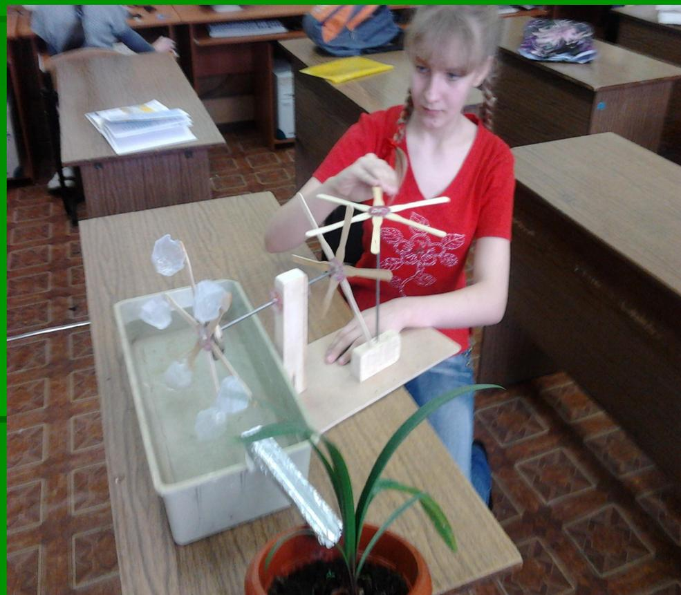
Приводное колесо расположено таким образом, чтобы при вращении зубчатая передача вращала персидское колесо. Вода зачерпывается и подается в желоб, а далее – в ирригационную сеть.
